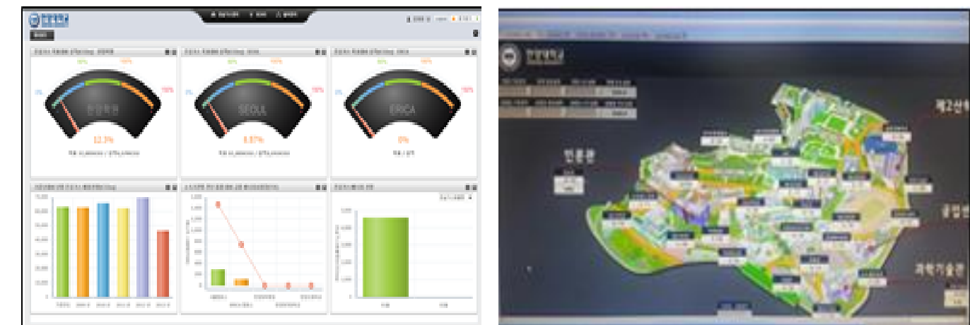
한양대학교 에너지자동검침시스템(좌) 개별 냉·난방기 통합제어시스템(우)
