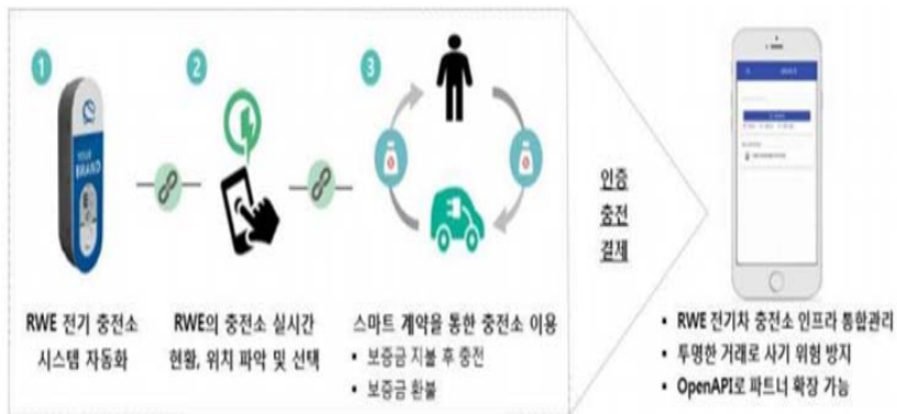
[그림 2-6] 이더리움 기반 EV 충전/지불 시스템
